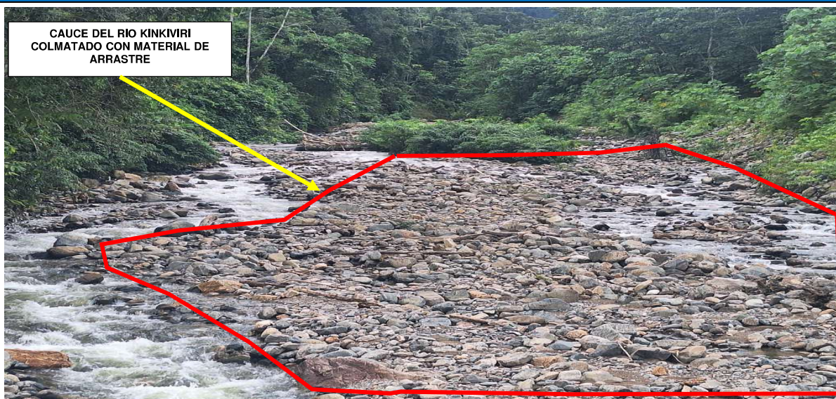
FIGURA N°01: COLMATACIÓN EN EL RÍO KINKIVIRI (AGUAS ARRIBA), EN EL SECTOR KINKIVIRI BAJA, DISTRITO DE UNIÓN ASHÁNINKA, PROVINCIA DE LA CONVENCION - CUSCO. MATERIAL DE ACARREO TIPO BOLONERÍA Y CANTO RODADO
